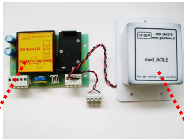
COLLEGAMENTO DELLA PILA ALLA SCHEDA
