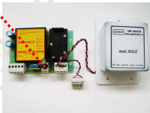
COLLEGAMENTO DELLA PILA E DEL MORSETTO DI PROVA ALLA SCHEDA
